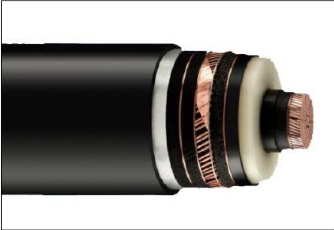
Bild 4.2. 380-kV-VPE-Einleiterkabel 2XS(FL)2Y 1×2500RM/50: 6-Segment-Millikenleiter, Kupferquerschnitt 2500 mm 2 , PE-Mantel, Kupferschirm mit 50 mm 2 Querschnitt, Aluminium-Dampfsperre, Außendurchmesser 14,2 cm (Quelle: Nexans)
