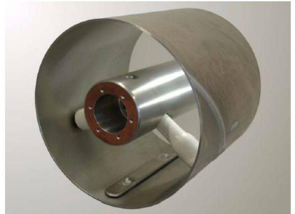
Bild 4.3. 380-kV-Gasisolierter Rohrleiter: Kapseldurchmesser außen 517 mm, innen 500 mm, Leiterdurchmesser außen 180 mm, innen 156 mm (Quelle: Siemens)
